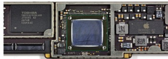
ipad3's CPU SoC Circuit → A5
